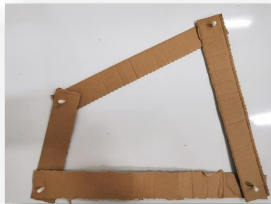
学生小组作业-自制平面连杆机构
